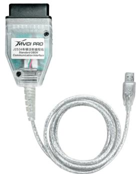
MVCI PRO J2534车辆诊断编程线示意图
